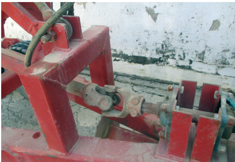
Segunda transmisión desprotegida en una máquina transformada
