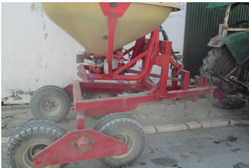
Abonadora suspendida transformada en arrastrada
