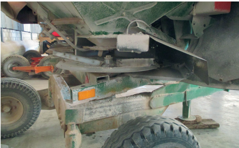
Limpieza deficiente de la abonadora
