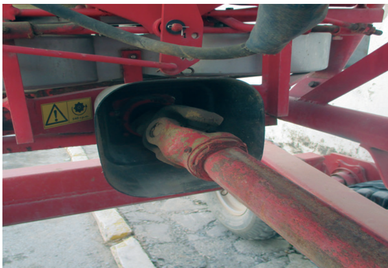
Eje de transmisión sin resguardo de protección
