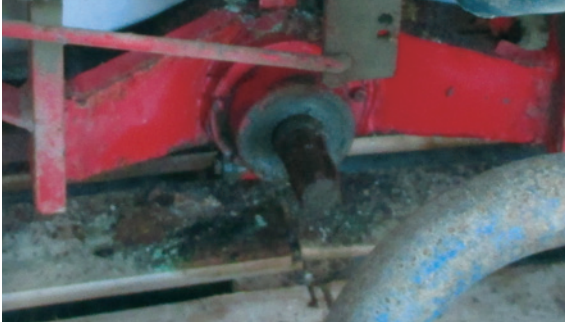
Eje receptor desprotegido
