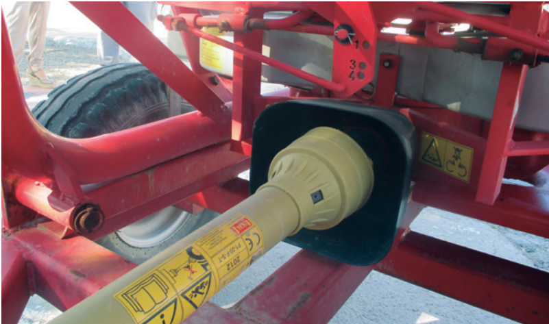
Protector del eje de transmisión desprovisto de cadenas de anclaje
