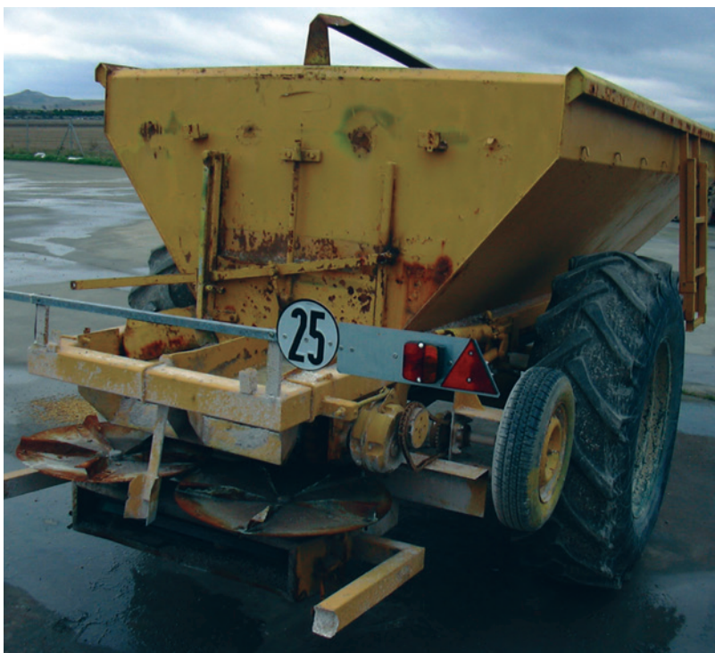
Discos en mal estado
