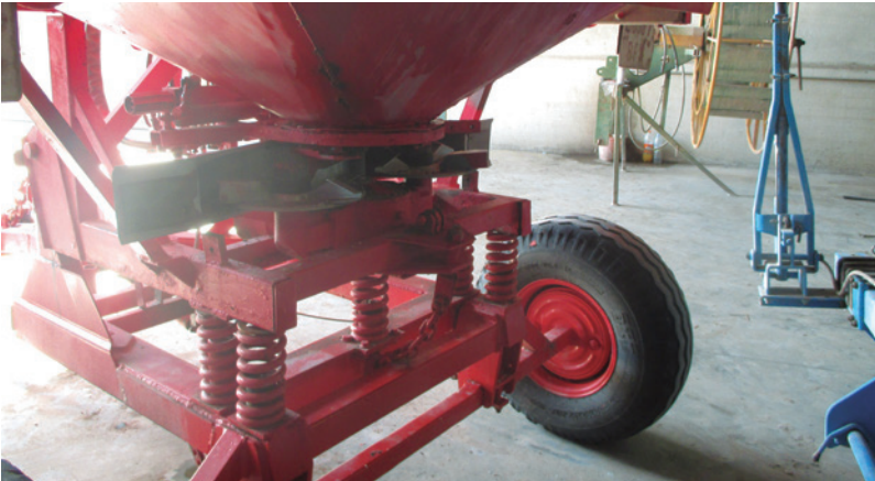
Componentes de distribución desprotegidos
