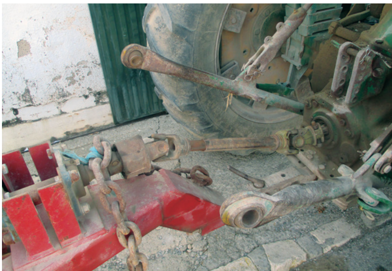
Primera transmisión desprotegida en una máquina transformada
