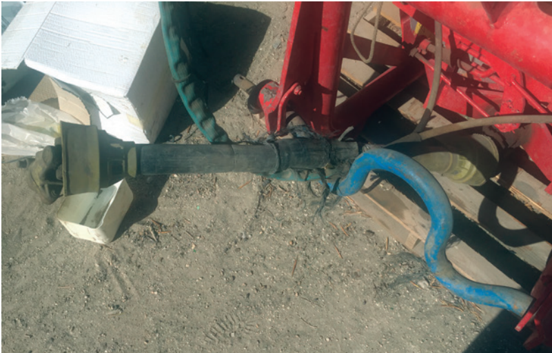
Deterioro del resguardo del eje de transmisión
