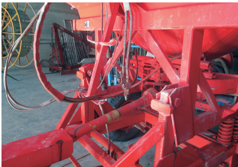
Deterioro del resguardo del eje de transmisión
