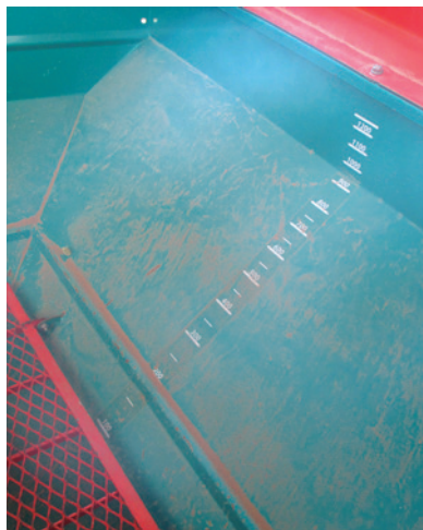
Abonadora marcada hasta 1200 litros, cuando su capacidad real es mayor
