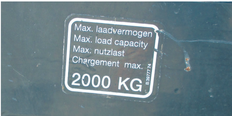
Marcado incorrecto de la capacidad de la tolva por no estar en español
