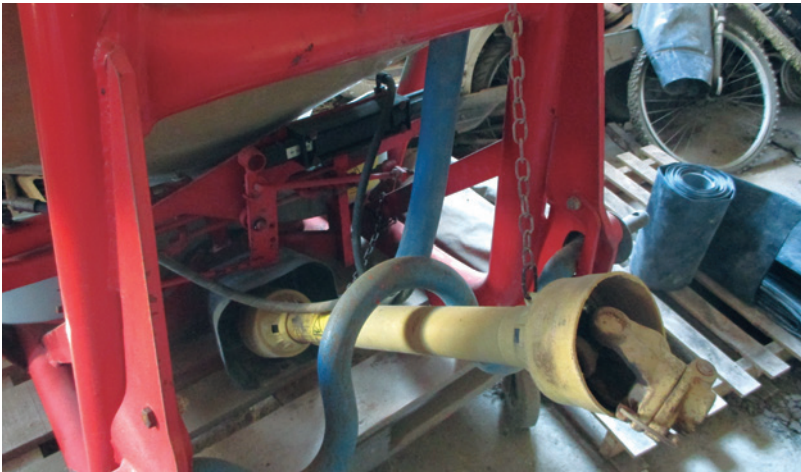
Uso incorrecto de la cadena de anclaje
