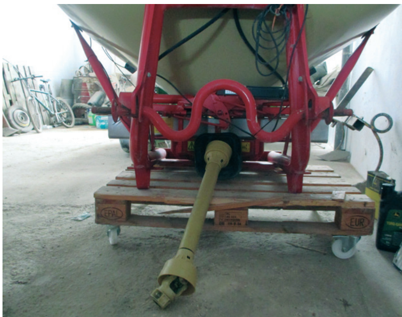
Presencia del resguardo del eje de transmisión de potencia
