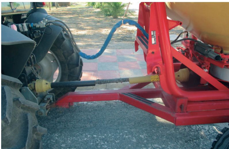
Longitud insuficiente del resguardo del eje de transmisión
