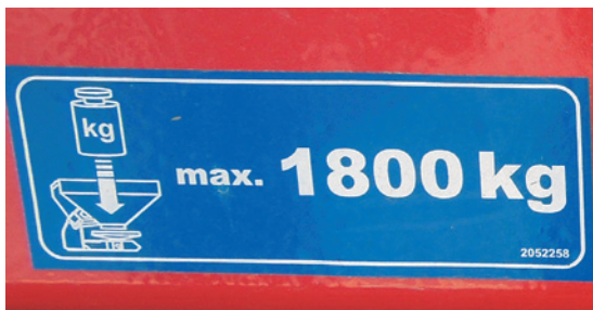
Marcado de la capacidad de la tolva
